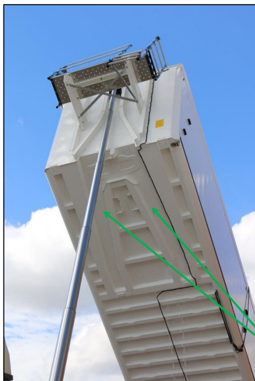
Zapuštění přední části rámu podvozku do dna muldy
