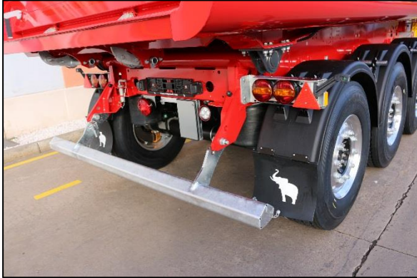
Zábrana proti podjetí v poloze při jízdě; zadní světla posazena výše
