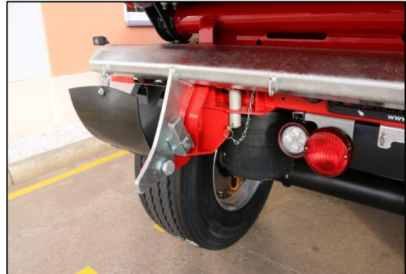
Bezpečné zajištění zábrany proti podjetí
